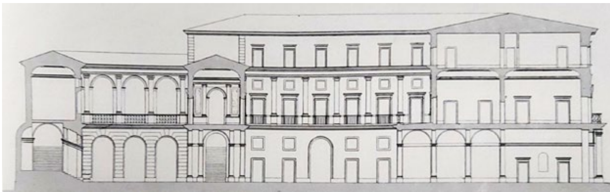
Figura 7. Sezione del palazzo Belmonte. La sezione è stata ribaltata orizzontalmente per agevolare il confronto con il disegno di Francesco Nicoletti (da HITTORFF 1835, planche 54).
