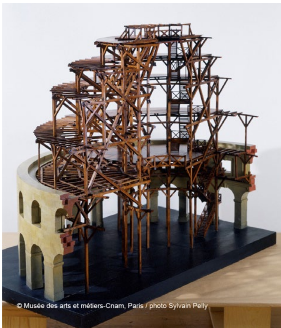
Figura 8. Modello del ponteggio costruito per la posa della cupola metallica dell' halle au blé , 1811-1812. Paris, Musée des arts et métiers, ©Musée des arts et métiers-Cnam/photo S. Pelly (da DUMONT SAINT-PRIEST 2019).
