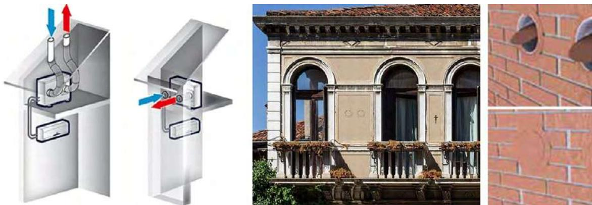
Figure 2a-b. Esempi di installazione motocondensanti a scomparsa: a) installazione in cavedi; b) griglie mobili in EPS.
