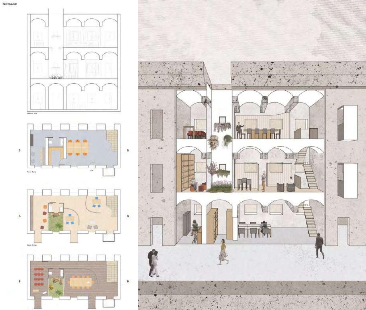
Figure 5-6. Esercizi progettuali sul carcere di Buoncammino. Ipotesi di “colonizzazione” di alcune celle del braccio detentivo meridionale, piante e sezioni e prospettiva (disegni tratti dalla tesi di Laurea Magistrale in Architettura di Giorgio Montis, a.Aa 2019-2020, relatori proff. P.F. Cherchi, D.R. Fiorino, M. Lecis).
