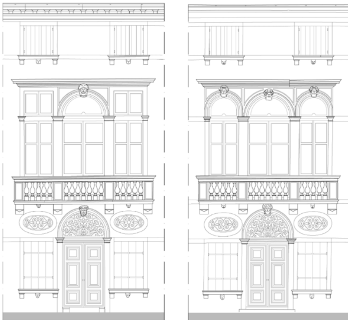
Figura 6. Dettaglio dei sistemi di aperture centrali sovrapposte, chiamate anche “serliane sovrapposte”, nei prospetti settentrionale e orientale (rilievo e restituzione E. Montalti 2018).
