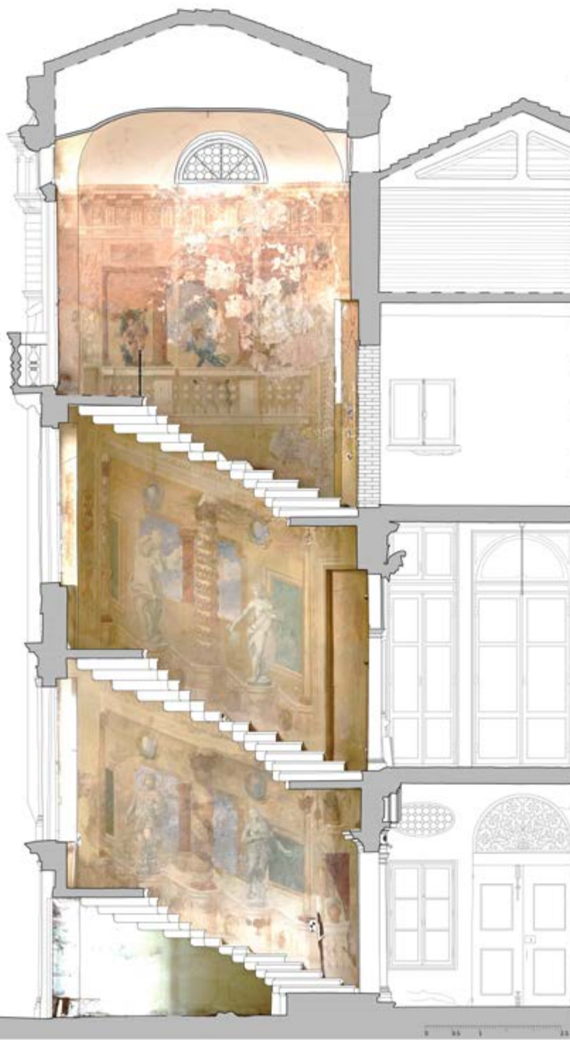
Figura 21. Canda (Rovigo). Villa Nani Mocenigo, rilievo della sezione settentrionale del corpo scale elicoidale con il ciclo decorativo di Gabriello Rossi (da MONTALTI 2020, tavola 2.10).
