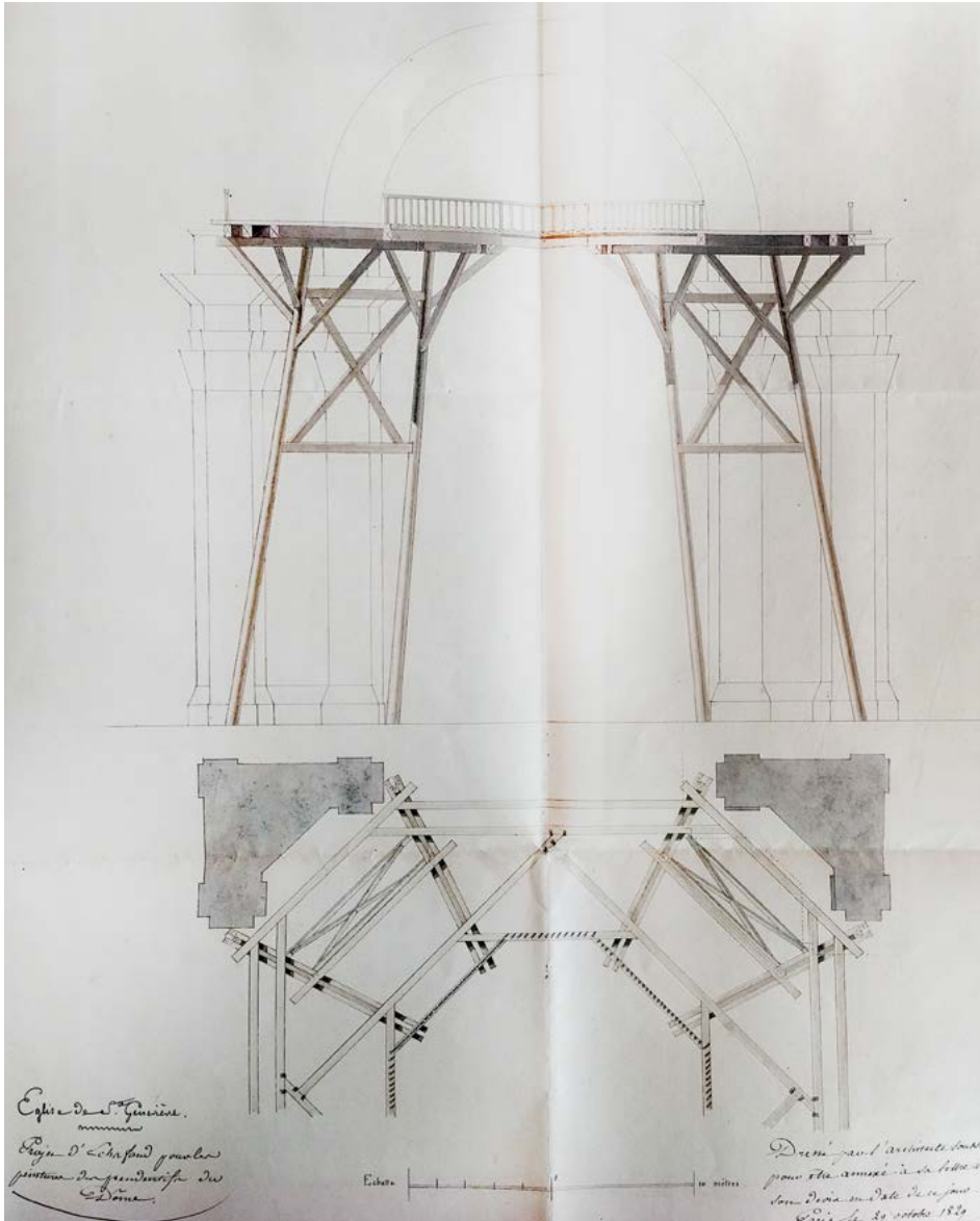
Figura 2. Louis-Pierre Baltard, Eglise de Sainte-Geneviève . Projet d'échafaudage pour les peintures des pendentifs du Dôme . Archives Nationales, Paris, Pierrefitte-sur-Seine série F, sous-série F/13, 1144, 29 octobre 1829.
