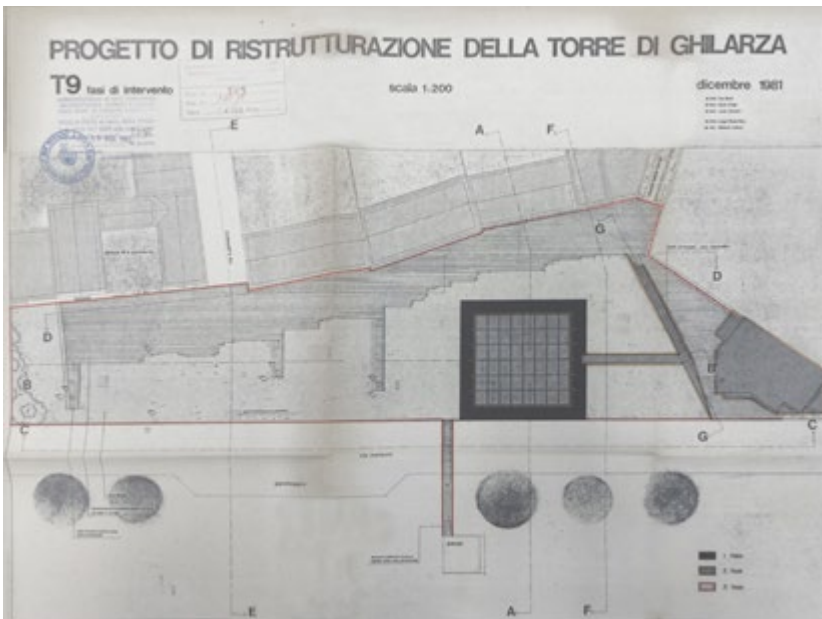
Figura 27. Ghilarza (OR), donjon aragonese, progetto di ristrutturazione della Torre di Ghilarza, planimetria con le fase di intervento, dicembre 1981. ASSABAPCA, Fondo Documenti, Ghilarza, Torre Aragonese, Sede: struttura museale, Cartella 1, 1973/80, tav. 9.
