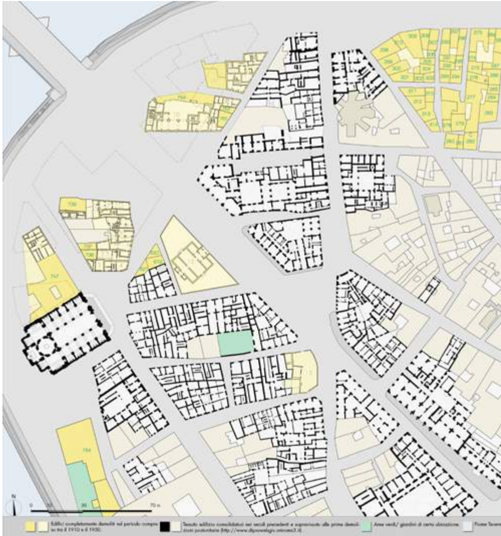
Figura 30. Analisi della trasformazioni urbane e architettoniche: dal secondo decennio del Novecento al 1945 (da GNAVI 2016, stralcio della tavola 4). La planimetria, redatta sulla base di documentazione archivistica, mostra in giallo l'entità delle demolizioni perpetuate nel periodo considerato ai danni dei tessuti storici (rielaborazione dell'autore).
