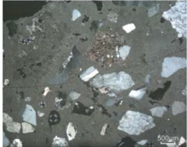
PALAZZO DI RE BALDO | Luogosanto RO05 | Aggregato di natura granitoide, presenza di cocciopesto
