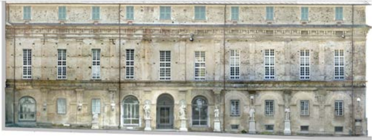
Figura 8. Savona, santuario di Nostra Signora della Misericordia. Restituzione del rilievo in fotogrammetria digitale piana del fronte principale dell'Ospizio dei poveri (elaborazione Laboratorio MARSC-DSA, 2011).
