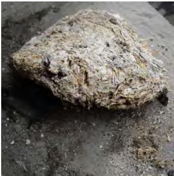
In senso antiorario, figura 36. Resti del riempimento di calce e paglia distaccatosi da una muratura con struttura portante in legno (foto B. Scala); figura 37. Mescola di canapa e calce in betoniera (foto B. Scala); figura 38. Diversi colori di argilla in base alla provenienza (foto B. Scala).
