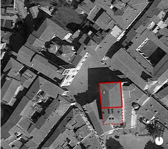
Figura 1. Bevagna, veduta area di piazza Filippo Silvestri. In rosso con linea continua l'ingombro del Palazzo dei Consoli nel Medioevo, in rosso tratteggiato il nuovo corpo di fabbrica costruito nell'Ottocento per ospitare il palco del Teatro Francesco Torti (elaborazione grafica A. Carannante, 2023).
