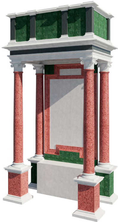
Figura 11. Ricostruzione virtuale 3D del pulpito cinquecentesco della cattedrale cosentina eseguita sulla base dei dati estrapolabili dal disegno di progetto e dalla documentazione d'archivio (elaborazione di R. D'Alessandro).
