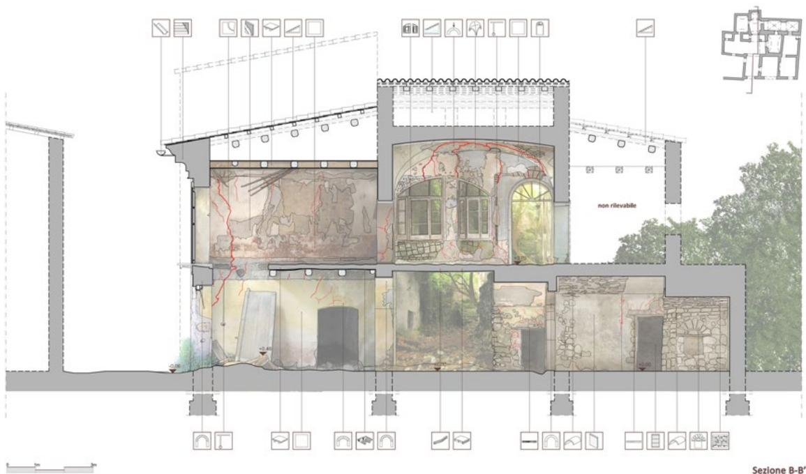
Figura 11. Tocco Caudio (Benevento). Rilievo dei materiali e delle tecniche costruttive di uno degli edifici del borgo (elaborazione di R. Cerbone, V.F. De Stefano, G. Di Donato, A. Esposito, Università di Napoli Federico II, Dipartimento di Architettura, corso di Laboratorio di Restauro, professoressa Valentina Russo, tutors Giovanna Ceniccola, Stefania Pollone, a.a. 2012-2013).
