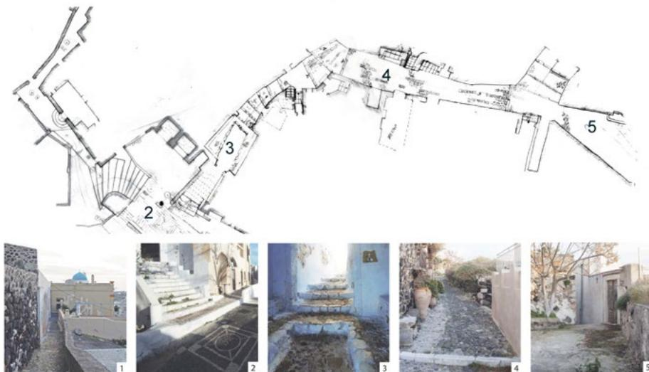
Figura 8. Carte tematiche: sistema di raccolta e allontanamento delle acque meteoriche, identificazione degli elementi lapidei di riuso e pavimentazioni dei percorsi e spazi pubblici (elaborazione di A. Drago, G. Manuella, E. Noto, 2019).
