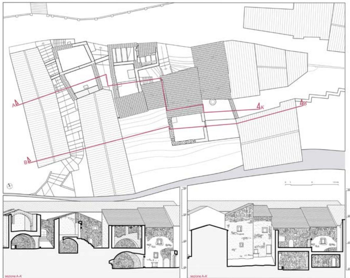
Figura 4a. Santo Stefano di Sessanio (L'Aquila). Rilievi in pianta e in alzato degli aggregati edilizi del nucleo storico lungo via della Torre (disegni di R.P Di Benigno, D. Di Virgilio, ALabRes, 2004-2005).
