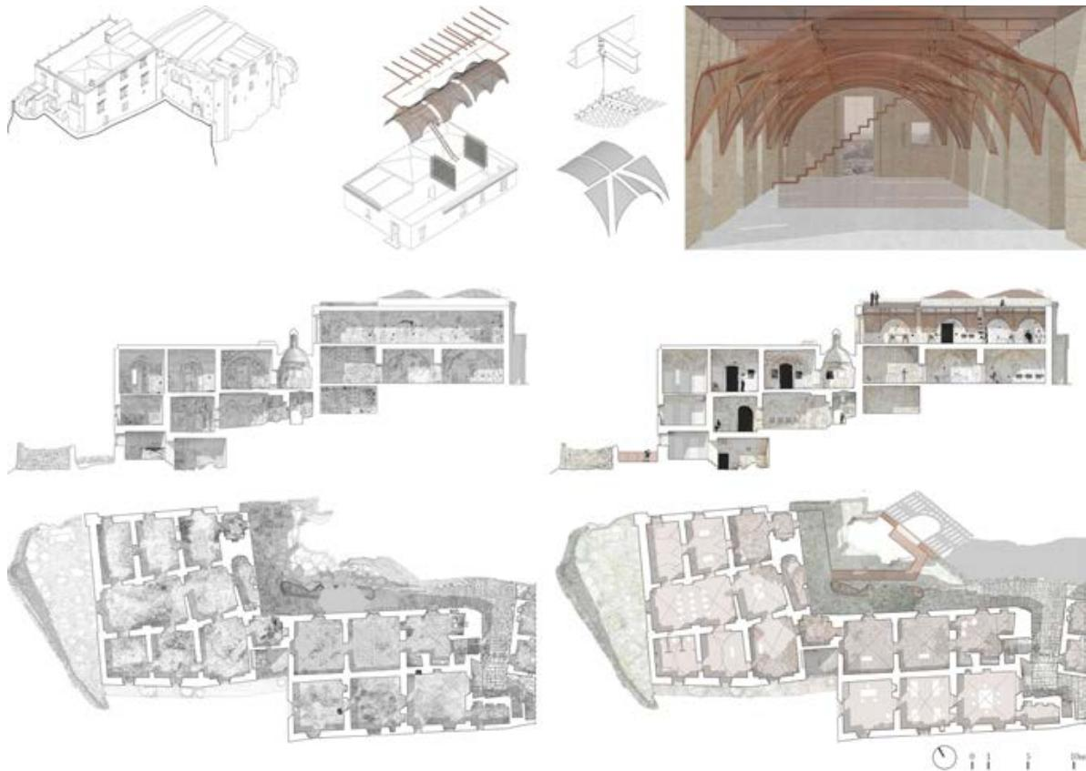
Figura 14. Interventi finalizzati al restauro del palazzo Carbone-Rigirone. I disegni di rilievo mostrano la presenza, al primo piano dell'edificio, di solai in laterocemento realizzati per sostituire le originarie strutture voltate in mattoni. Si propone la rievocazione della primigenia spazialità dei vani ricorrendo a strutture voltate realizzate in lamiera traforata di acciaio corten (elaborazione di S. Belmondo, M.A. Catella, M. Intini, M. Madio, G.S. Orofino, P. Vitucci, 2015)
