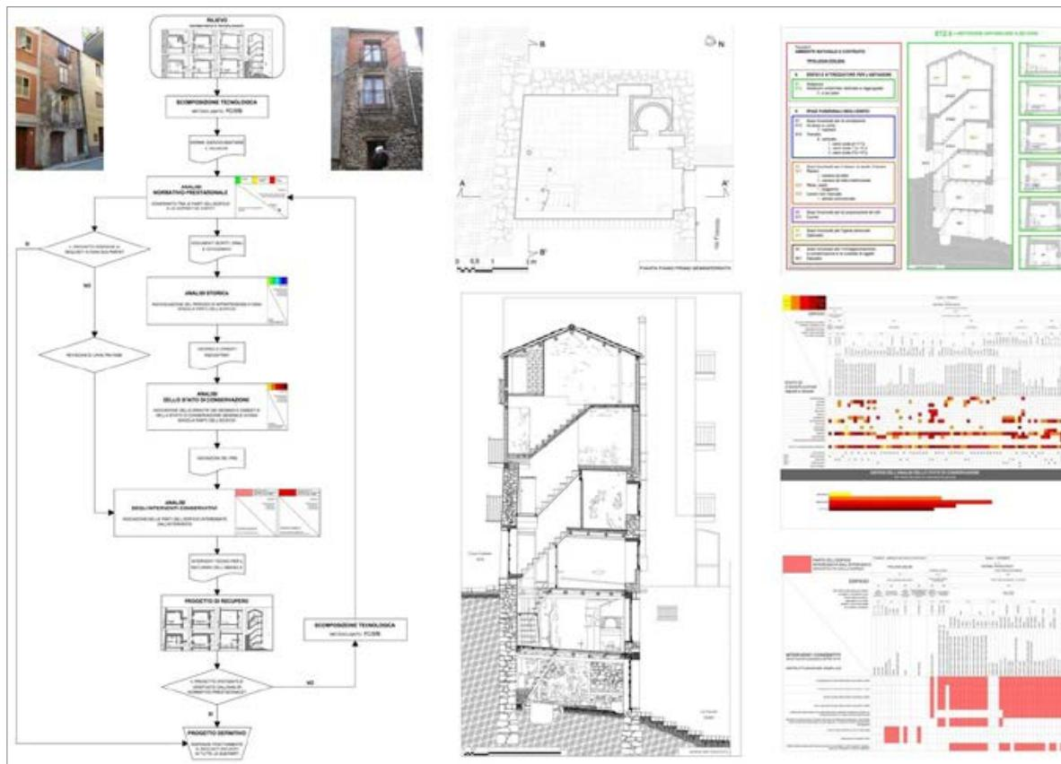
Figura 1. Analisi e metodologie per l'intervento in una unità edilizia tipo nel centro storico di San Mauro Castelverde (Palermo), (disegni e elaborazione C. Scialabba, tesi di laurea *Ipotesi metodologica di analisi tecnologica delle unità edilizie tipiche dei centri storici per il progetto di recupero*, Università degli studi di Palermo, Facoltà di Architettura, Corso di laurea in Restauro, Recupero e Riqualificazione dell'Architettura, relatore A. Mami, a.a. 2010-2011).
