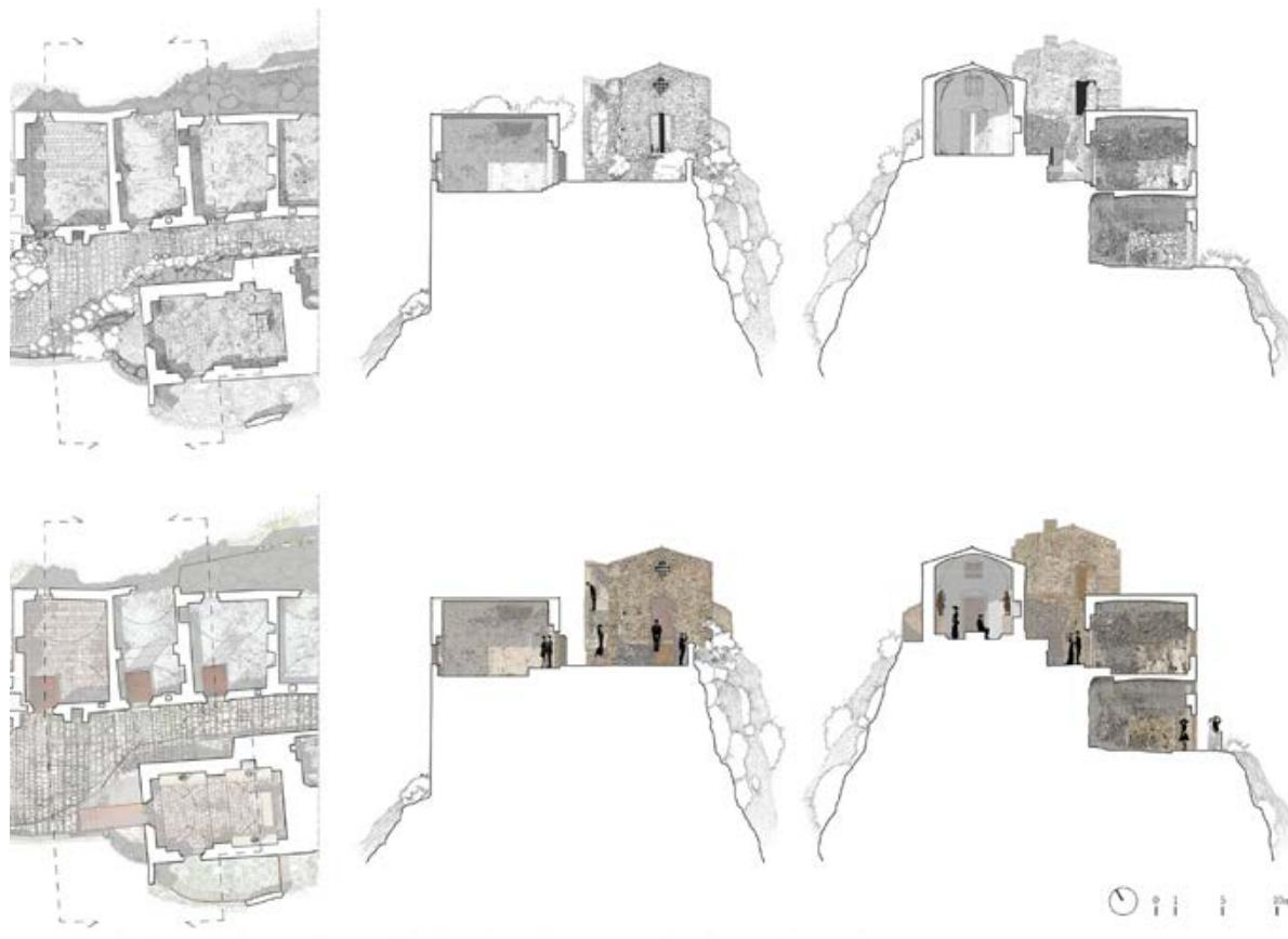
Figura 12. Proposta di intervento finalizzata al recupero della cappella di Santa Barbara, destinata ad accogliere il Museo della Statuaria di Craco. Rilievo architettonico, in alto, ed elaborati di progetto, in basso (elaborazione di S. Belmondo, M.A. Catella, M. Intini, M. Madio, G.S. Orofino, P. Vitucci 2015, M.A. Catella, 2016)
