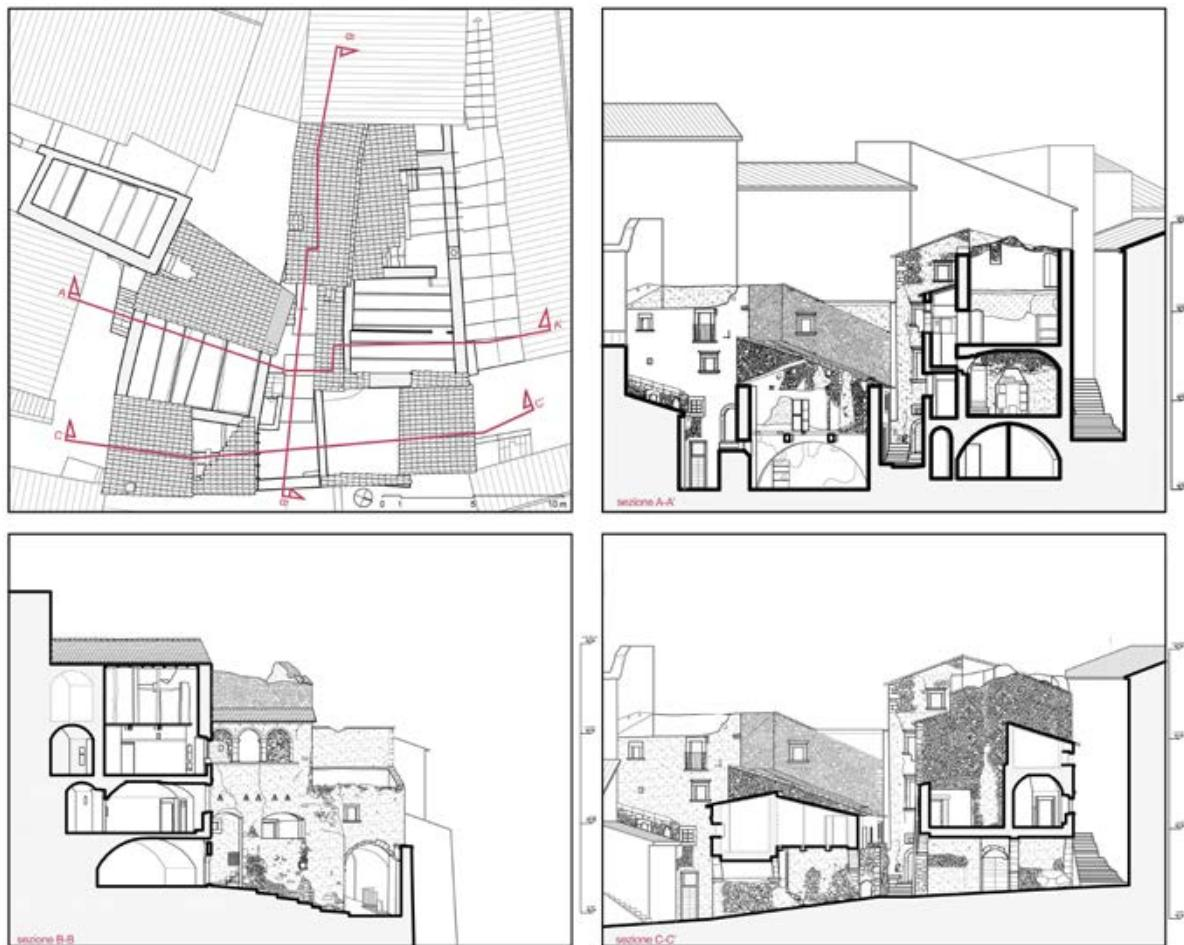
Figura 4b. Santo Stefano di Sessanio (L'Aquila). Rilievi in pianta e in alzato degli aggregati edilizi del nucleo storico lungo via Boragna (disegni di R.P Di Benigno, D. Di Virgilio, ALabRes, 2004-2005).
