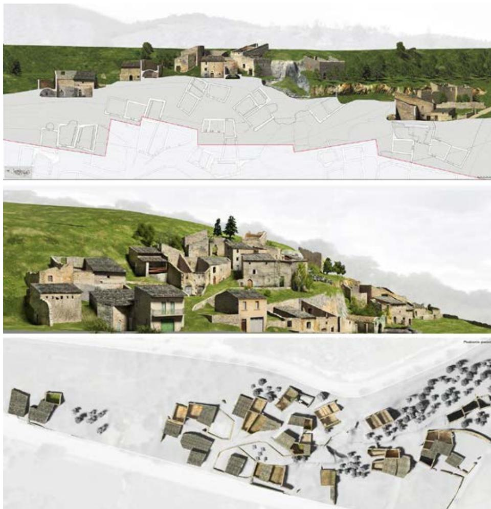
Figura 3. Secinaro (L'Aquila). Rilievi in pianta e in alzato dei resti delle cosiddette "pagliare", edifici che costituiscono l'ossatura portante delle frazioni rurali dell'Abruzzo interno (disegni di V. Panicali, ALabRes, 2009-2010).
