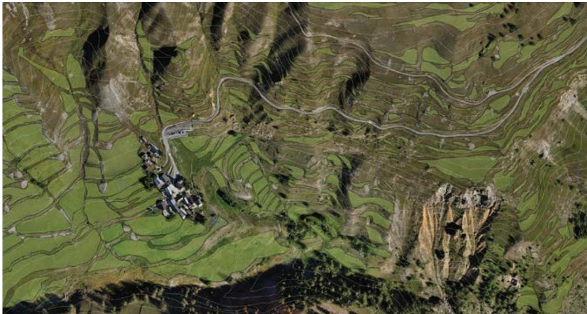
Figura 2. Individuazione di aree terrazzate nei dintorni della borgata di Ferriere da analisi spaziali del DSM (*Digital Surface Model*) ottenuto dal volo fotogrammetrico realizzato mediante il drone ad ala fissa *Ebee* della *SenseFly* (426 fotogrammi con risoluzione 4000x3000 pixel, area ricoperta 0.95 Km<sup>2</sup>, dimensione del pixel a terra GSD 5.79 cm, errore medio (RMS) 0.027 m.). Gli aerali sono sovrapposti all'ortofoto relativa al medesimo volo (SPANÒ ET ALII 2018).
