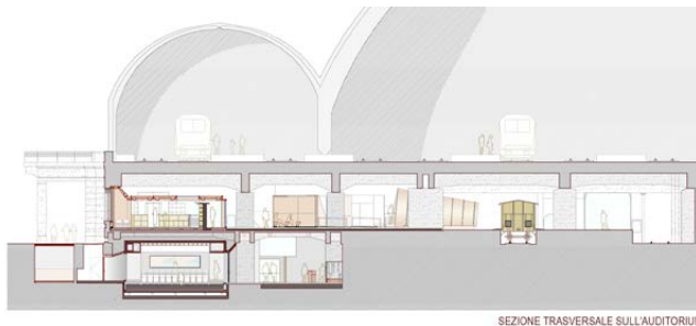
Figura 21. Sezione trasversale sull'auditorium (© Morpurgo de Curtis ArchitettiAssociati).
