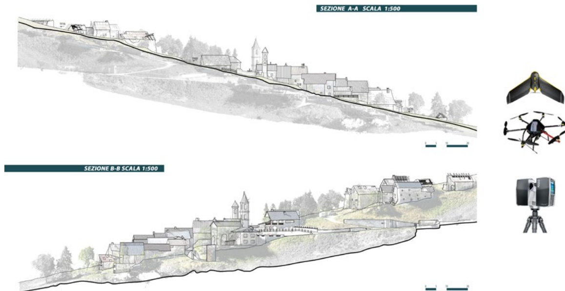
Figura 6. Restituzione dei due fronti del villaggio di Ferriere (ovest ed est) dalla nuvola di punti 3D elaborata dal volo fotogrammetrico eseguito mediante drone multi-rotore (elaborazione di K.E. Grasso, N. Latella, M. Palumbo, a.a. 2016-2017).
