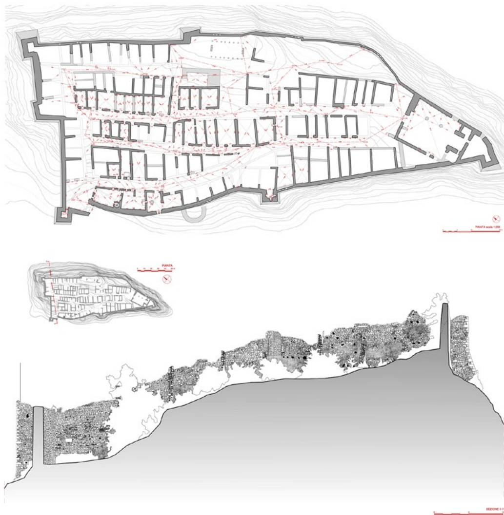
Figura 2. Ocre (L'Aquila). Pianta e sezione trasversale dei lacerti murari del castello (disegni di D. Avenali, D. Filippone, ALabRes, 2004/2005).
