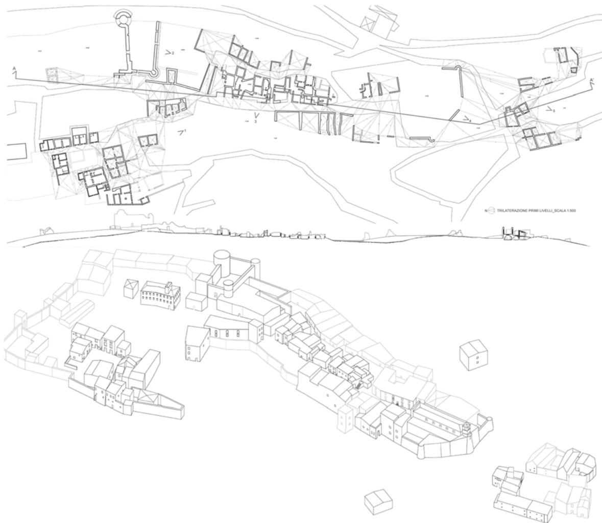
Figura 1. Alba Fucens (L'Aquila). Pianta quotata, sezione longitudinale dei resti del castello e ipotesi di ricostruzione presisma (disegni di G.A. Dalena, L. De Girolamo, M. Lattanzio, ALabRes, 2005/2006).
