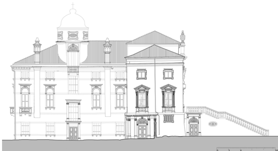
Figure 34-35. Canda (Rovigo). Villa Nani Mocenigo, ipotesi ricostruttiva della configurazione del prospetto settentrionale (in alto) e quello occidentale (in basso) secondo quanto rappresentato nella veduta di Ca' Rezzonico e nel Catasto Valdentro del 1779 (da MONTALTI 2020, tavola 2.8).
