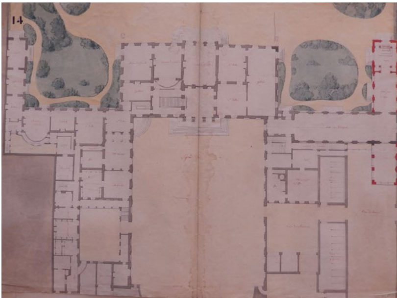
Figure 10. Étienne-Chérubin Leconte (attribué à), plan partiel du rez-de-chaussée de l'Élysée après la construction de l'escalier d'honneur et de la salle de banquet. Rez-de-chaussée avec l'indication de l'affectation des pièces et, en rouge, projet non exécuté d'agrandissement et prolongement de l'aile ouest, pour Joachim Murat, grand-duc de Berg et Clèves, dessin, crayon, encre noire et aquarelle, s.d. [avant 1808]. Paris, Archives nationales, Cartes et plans, VA XII, 5 (© Geoffroy, Guidoboni 2018).
