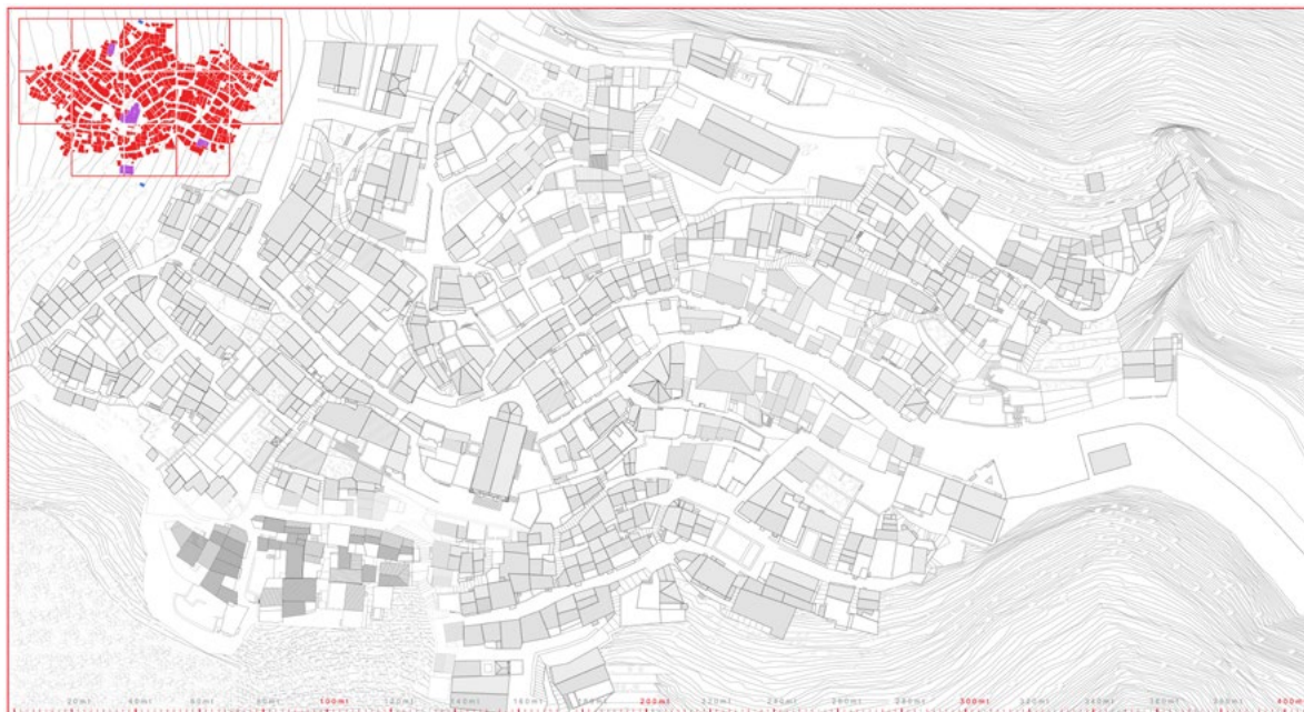
Figura 4. Casalvecchio. Pianta coperture. Restituzione del rilievo strumentale terrestre e aereo. Esiti corso di Rilievo dell'architettura a.a. 2017-2018 (elaborazione grafica a cura di M. Arena, 2019).
