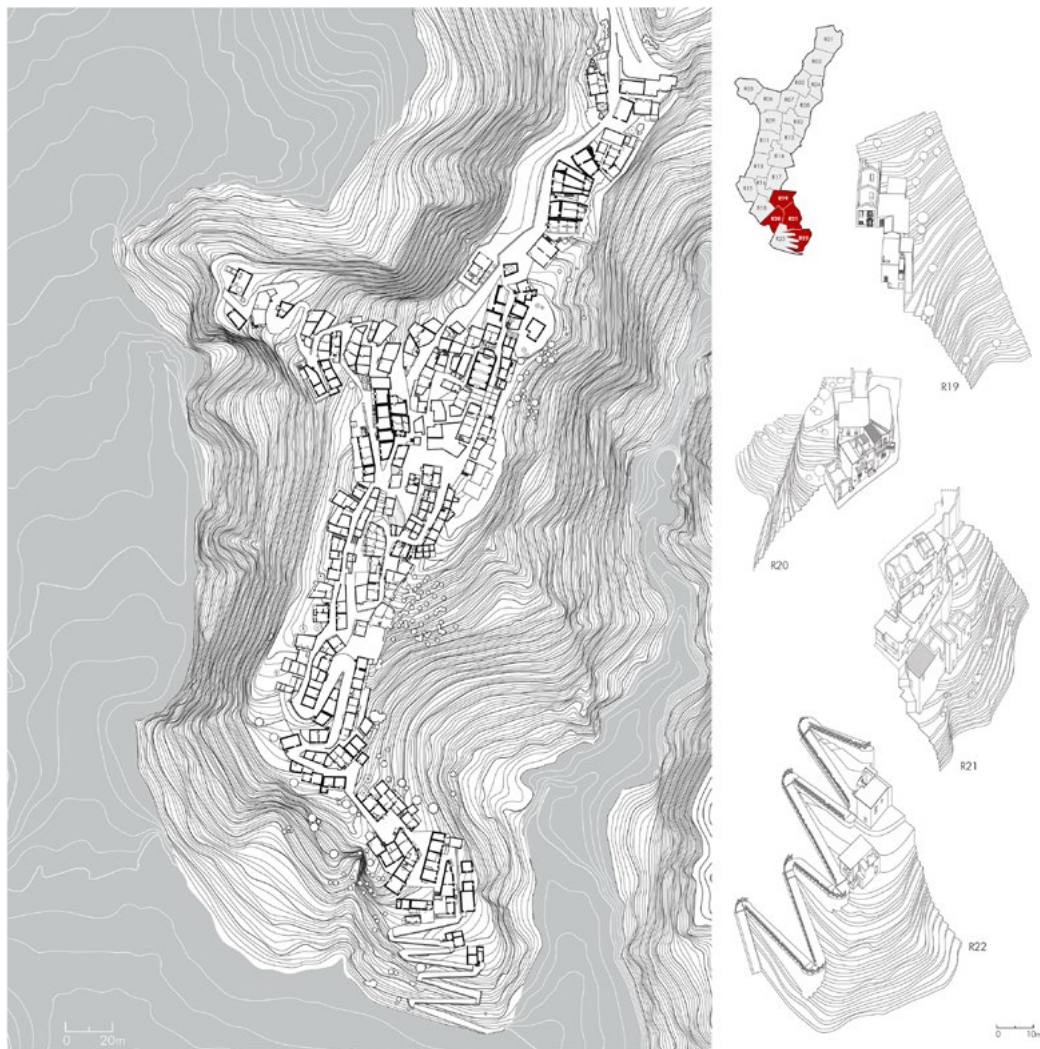
Figura 3. Roghudi. A sinistra: planimetria alla quota del suolo (ricomposizione dell'abitato di M.L. Bosco e G. Caccamo). A destra: assonometria di tre unità omogenee contigue (disegni di C. Fera, A. Lombardo, N. Montagno, C. Moschella, K. Pansera, P.B. Praticò, L. Spadafora, I. Spasari).
