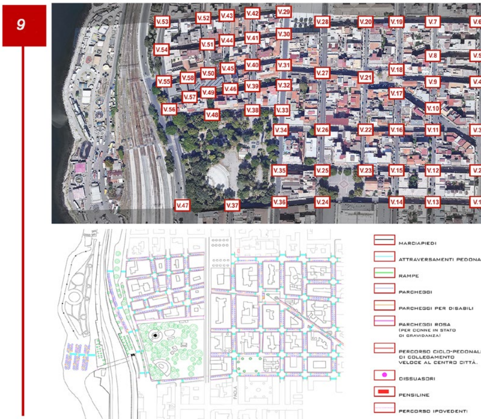
Figura 3. Mappatura dei nodi stradali e valutazione degli elementi caratterizzanti nel sub-ambito 3 - zona Villa Comunale (Workshop “Città a misura di anziano. Dal rilievo del concetto al progetto di città accessibile”, organizzato dal Corso di Accessibilità, fruibilità e sicurezza degli spazi – prof. F. Bagnato e dall’UdR del Progetto In-AGE di Reggio Calabria, maggio-giugno 2019).
