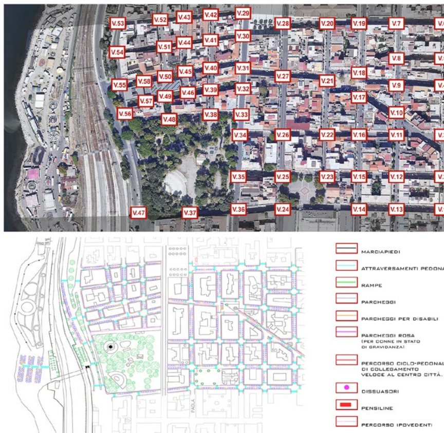
Figura 3. Mappatura dei nodi stradali e valutazione degli elementi caratterizzanti nel sub-ambito 3 - zona Villa Comunale (Workshop “Città a misura di anziano. Dal rilievo del concetto al progetto di città accessibile”, organizzato dal Corso di Accessibilità, fruibilità e sicurezza degli spazi – prof. F. Bagnato e dall’UdR del Progetto In-AGE di Reggio Calabria, maggio-giugno 2019).
