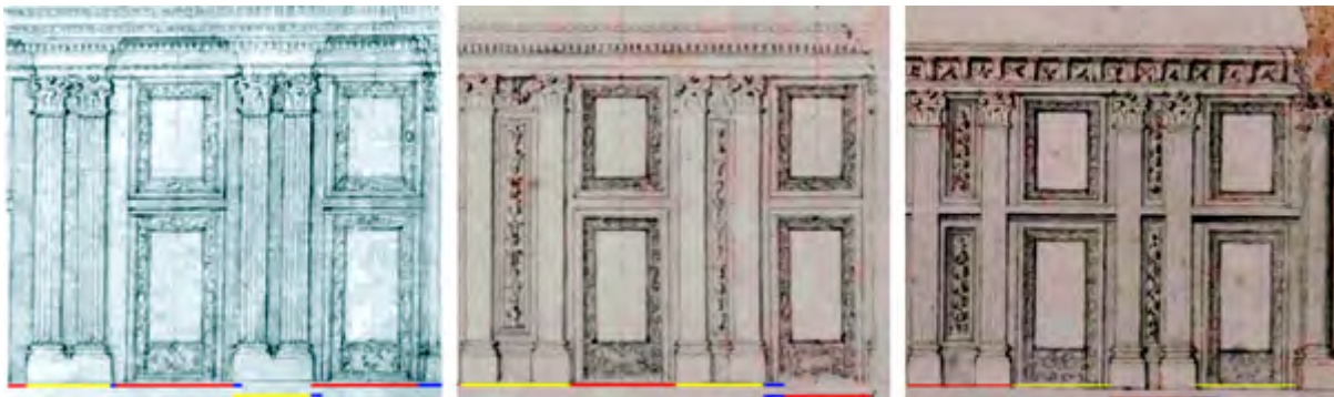
Figura 13. Album di disegni d'architettura, particolari dei ff. 139r, 141r e 142r. In basso a ciascuna immagine è evidenziato in rosso e giallo il passo costante delle porzioni di muro e degli interassi delle finestre nella sala centrale della Galleria Colonna e in blu gli scarti di queste dimensioni nell'ultima porzione e interasse verso ovest.
