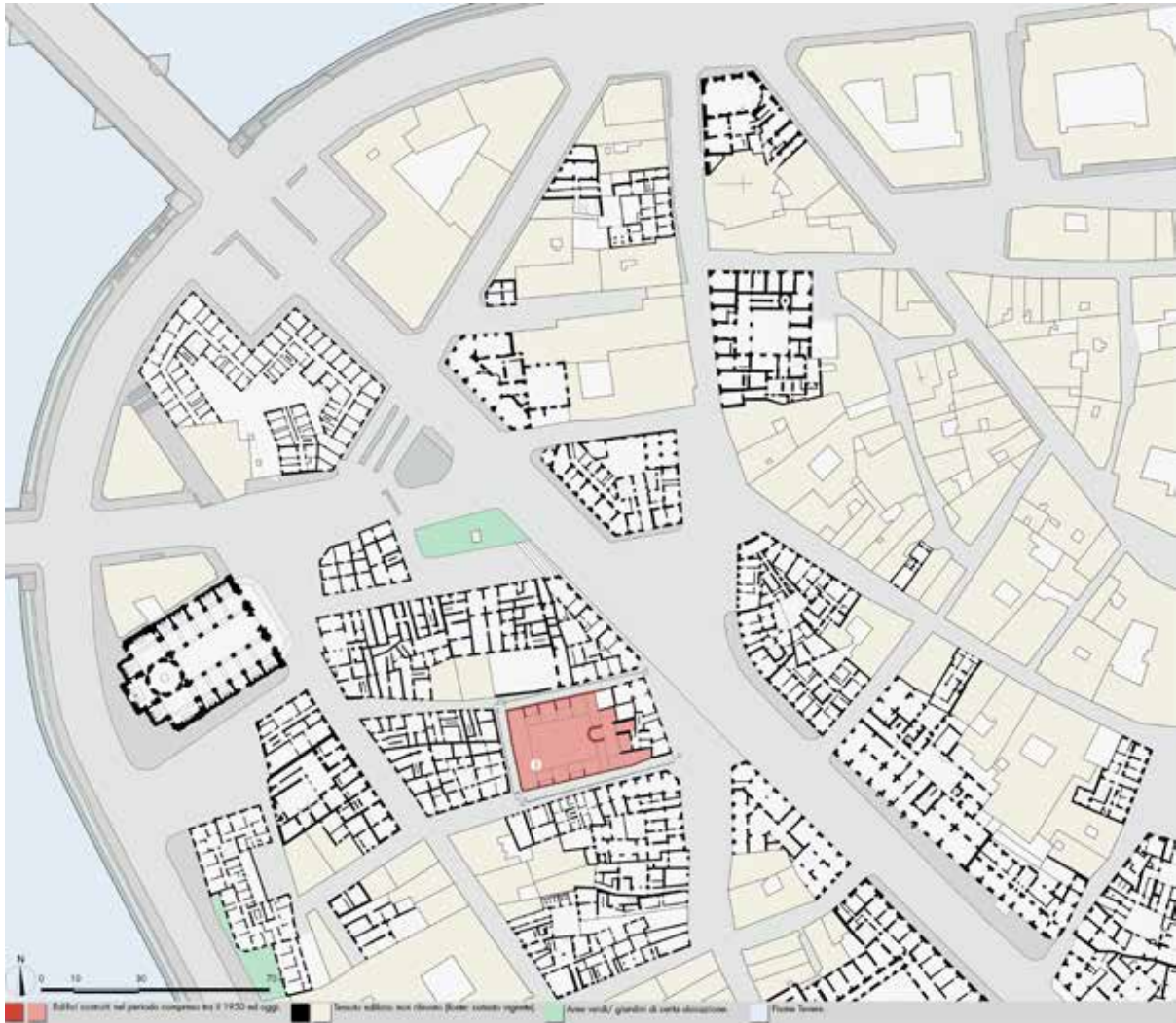
Figura 39. Analisi della trasformazioni urbane e architettoniche: le ultime demolizioni e risistemazioni del tessuto edilizio (1950 - inizi del Duemila) (da GNAVI 2016, stralcio della tavola 5). La planimetria, redatta sulla base della documentazione archivistica di riferimento, mostra in rosso le piante delle strutture costruite ex novo nel secondo dopoguerra (rielaborazione dell'autore).
