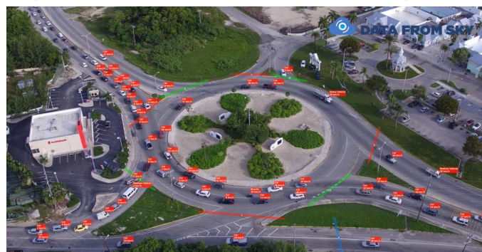
Fig. 5 - Elaborazione automatica delle immagini video. (fonte: propria elaborazione)
