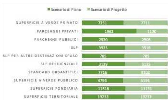
Fig. 3 - Sintesi e confronto dei parametri urbanistici previsti dallo scenario di Piano e di Progetto per l'area 3 Laghi Braccini. (fonte: propria elaborazione)
