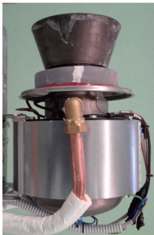
Fig.3 - Motore Stirling con la testa tronco conica di assorbimento del calore montata frontalmente (in alto nell'immagine)
