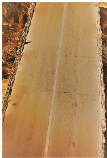
Fig. 6 - Cambio cromatico per far risaltare le difettosità all'analisi visiva (fonte: propria elaborazione)
