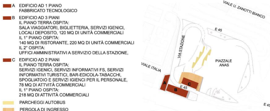
Fig. 1 – Schema funzionale del nuovo nodo intermodale di Villa San Giovanni [fonte: Il partenariato pubblico - privato per la realizzazione di un nodo intermodale a Villa San Giovanni, tesi di laurea in Architettura, Università degli Studi Mediterranea, Reggio Calabria, 2014]
