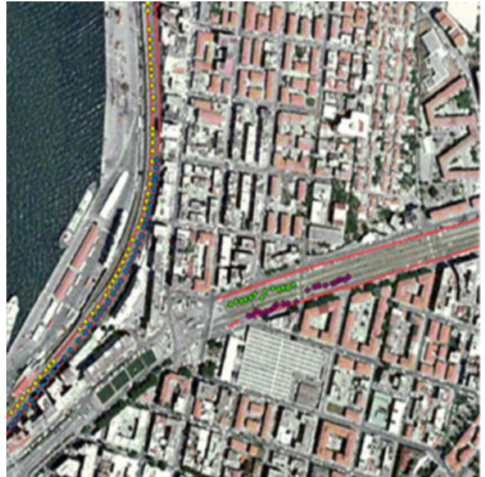
Fig. 2 - Punti riprodotti tramite EGNOS (sulla destra) e RTK (sulla sinistra).
