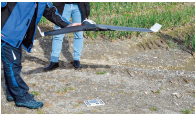
Fig. 3 - Il drone ad ala fissa Parrot Disco-Pro AG utilizzato per il rilevamento multispettrale. In foto, la fase di pre-calibrazione effettuata prima dell'esecuzione del volo utilizzando un pannello a riflettanza nota. (fonte: nostra elaborazione)
